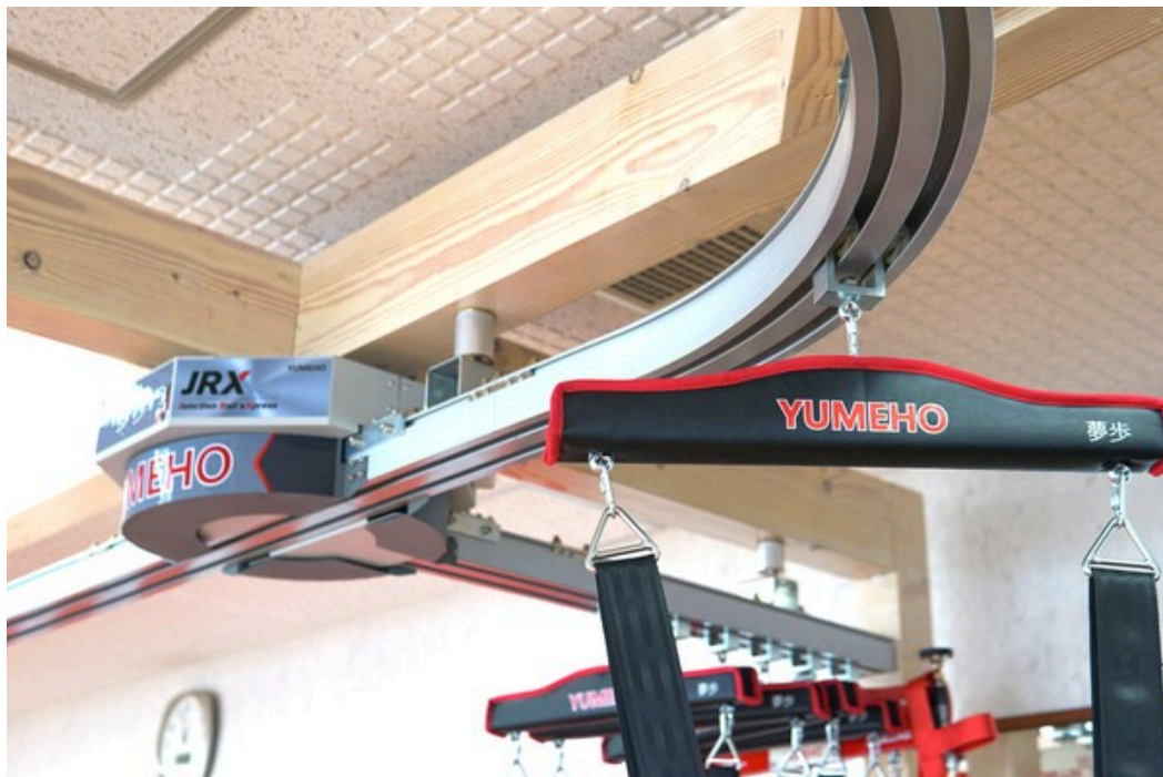
歩行サポート機器「夢歩」。天井レールに設置されたハンガー部分にハーネスを取り付ける
